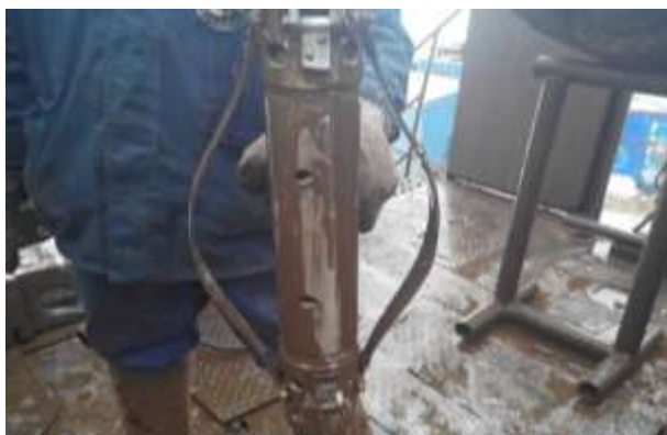
Рисунок 1. Отсутствие одной рессоры центратора после извлечения прибора из скважины № 150 ВНБ
