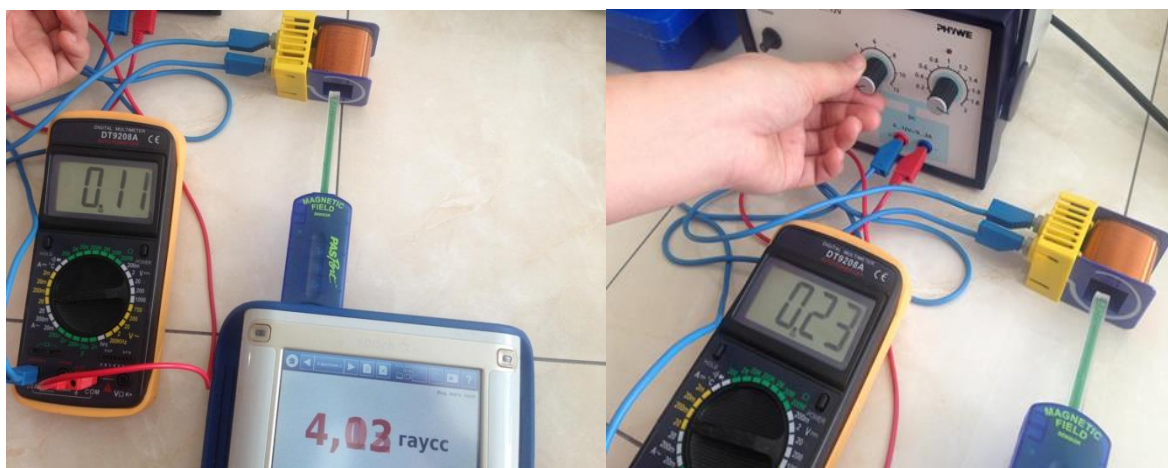
Сурет 2. Ток күшін арттырғанда, магнит өрісі ататынына көз жеткізу
