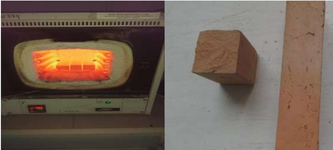
Сурет 2 – Отқа төзімді кірпішті 1800 °С арнайы пеште күйдіру
