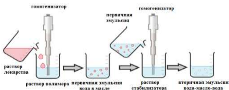
Рисунок 1 – Схема получения полимерных наночастиц методом двойной эмульсии
